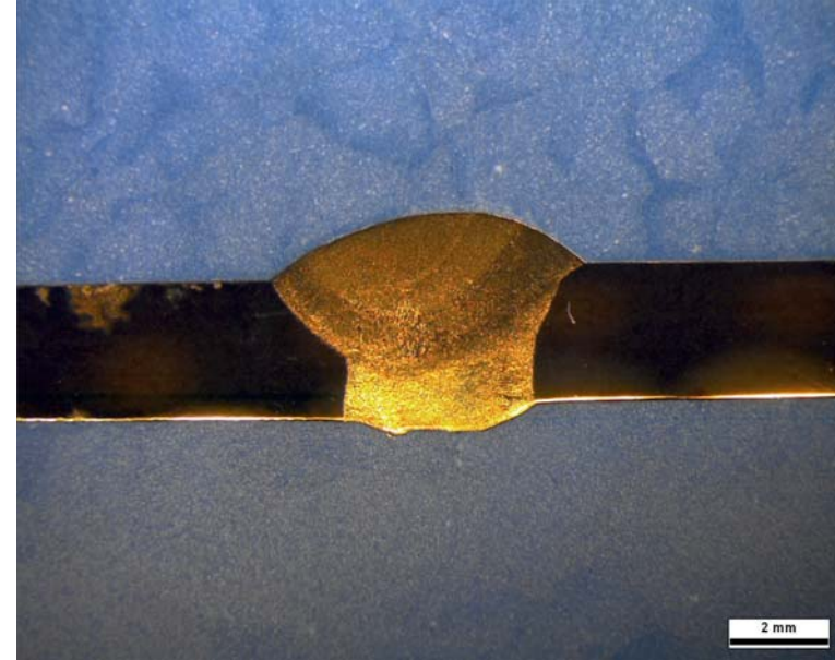
Makroaufnahme Stumpfnah Werkstoff: Hastelloy C276
